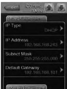
Данные параметры используются только при передаче данные через встроенный интерфейс BACnet IP.
