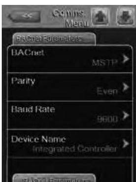
Приведенные далее параметры отображаются только при значении MSTP параметра BACnet.
