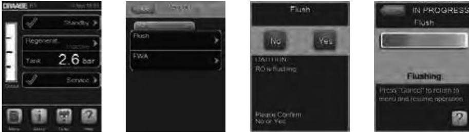
1. Нажать кнопку Drain (Слив) на главном экране дисплея. На дисплее появится меню Manual (Ручн. реж.)
